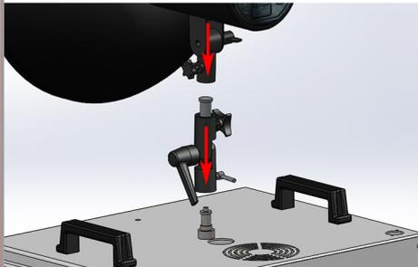
5 Wenn Du die gewünschte Neigung eingestellt hast, kannst Du die beiden Flügelschrauben festziehen.
