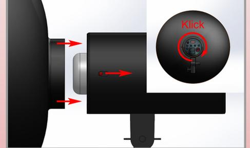
4. Jetzt kann der Blitz inkl. Schirmneiger auf der Fotobox befestigt werden. Der Schirmneiger ist evtl. schon am Blitz befestigt und muss nur ausgeklappt werden.
