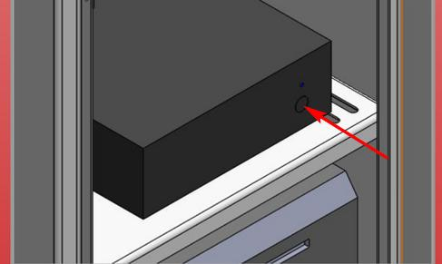
10. Am Objektiv der Kamera kannst Du durch drehen die gewünschte Brennweite (Bildausschnitt) einstellen. Das machst Du am Besten während des LiveView.
